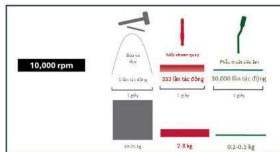
Hình 3. Tần số cơ học liên quan đến cơ chế cắt của các dụng cụ phẫu thuật 20 .
